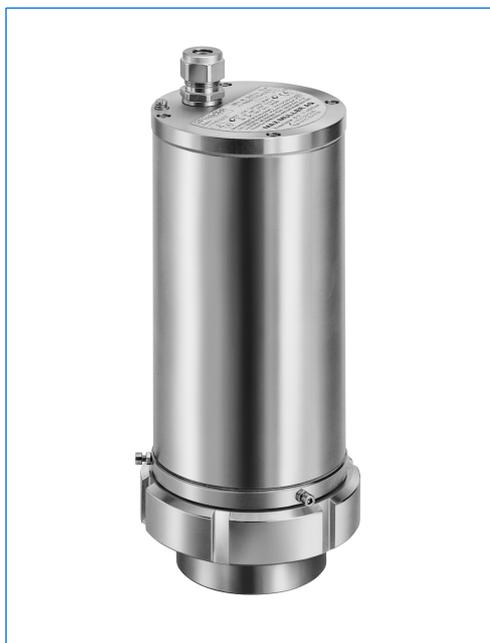
Projecteur type EdelEx G20 dH R80 K1, 20 W, 230 V, Ex d IIC T5 Gb, Ex t IIIC T95°C Db IP67, Ex II 2 G + D, avec fixation par disque à col étiré «R 80» sur hublot vissé similaire à DIN 11851, PN 6, DN 80.
