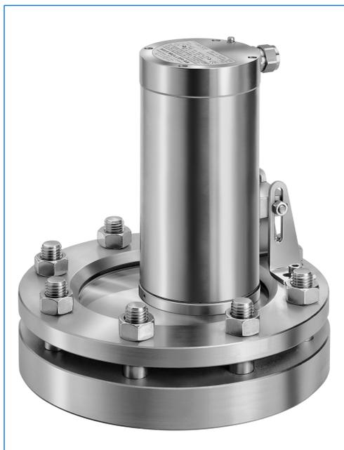
Projecteur type EdelEx 50 dH Sch K2, 50 W, 230 V, Ex d IIC T4 Gb, Ex t IIIC T130°C Db IP67, Ex II 2 G + D, avec fixation par charnière «Sch» sur hublot rond selon DIN 28120, PN 10, DN 150.
